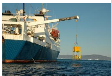
Et specialbygget undervandsinstrument, som er designet til at udforske de dybeste dele af verdenshavet
